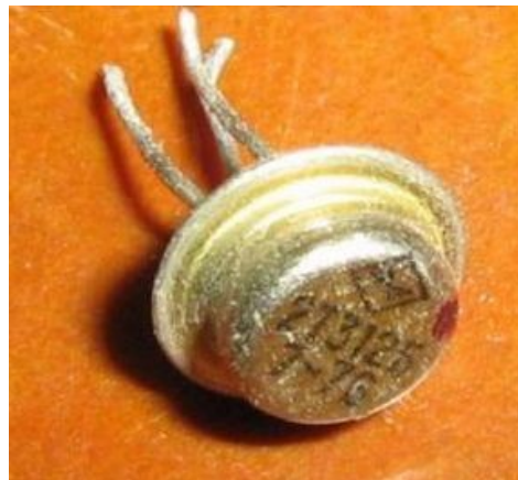
Кремниевый p-р-п транзистор 2Т312Б с позолоченным основанием и выводами.
